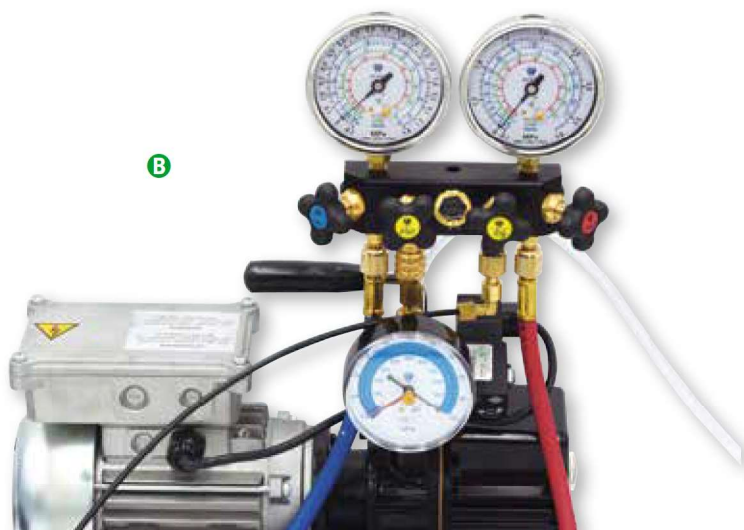
Particolare del kit dotato di elettrovalvola e vacuometro
